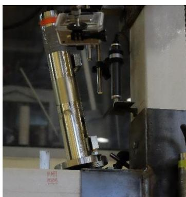
**Figura 37: Posição do inclinômetro I1 nos ensaios monotónicos.**
