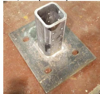
**Figura 33: Peça metálica de encastramento da coluna.**
